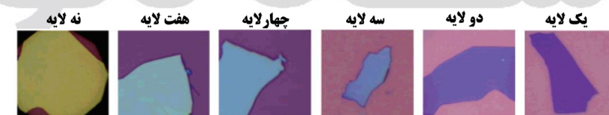
شکل ۳: تغییر رنگ ظاهری گرافن با افزایش تعداد لایه‌های آن
